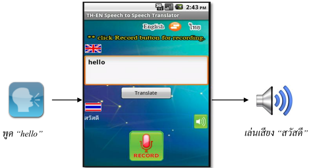
รูปภาพ 4.3 การทดสอบการแปลเสียงภาษาอังกฤษเป็นเสียงภาษาไทย
