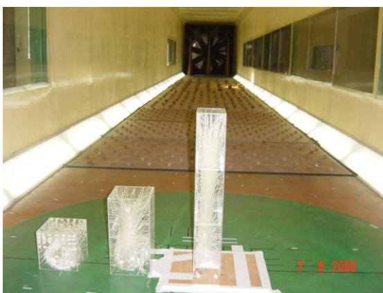
รูปที่ 1 แบบจำลองเชิงของอาคารเดี่ยว สูงปานกลาง และสูงในอุโมงค์ลม สำหรับทดสอบหาค่าสัมประสิทธิ์ของหน่วยแรงลม
