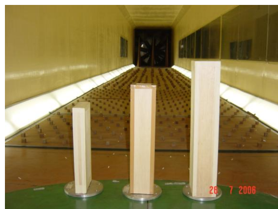
รูปที่ 2 แบบจำลองอาคารในอุโมงค์ลม เพื่อวัดแรงและคำนวณผลการตอบสนอง โดยวิธี High Frequency Force Balance
